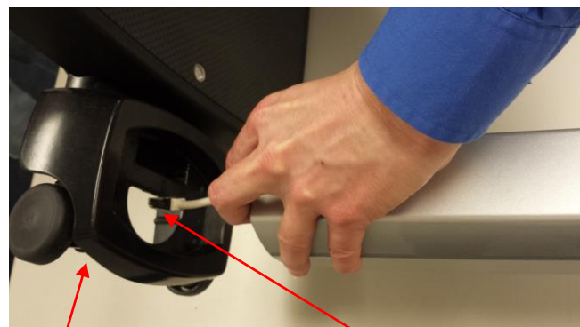
Base de la plateforme Connecteur du câble de la cellule de charge
