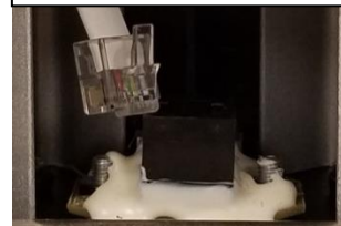
Câble de cellule de pesage non connecté
