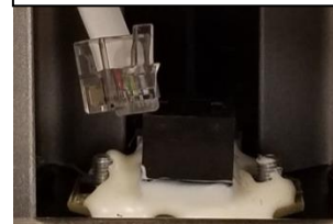
Câble de cellule de pesage non connecté
